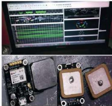
**Fig. 4** Interface del U-Center y modulo GPS con doble antena
