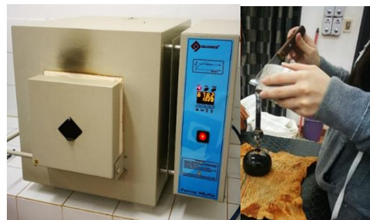
Figura 4. Horno mufla utilizado para el ensayo de pérdida al fuego y ensayo de densidad real de la CCA (izquierda).
