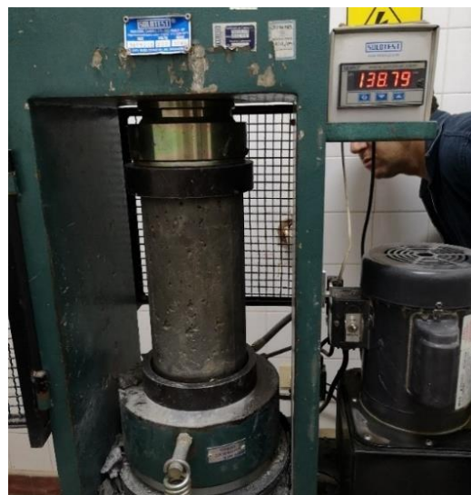
Figura 7. Rotura de un cuerpo de prueba, indicándose la carga última de rotura.
