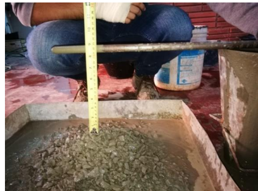
Figura 6. Segregación en mezcla básica con alto contenido de superplastificante.
