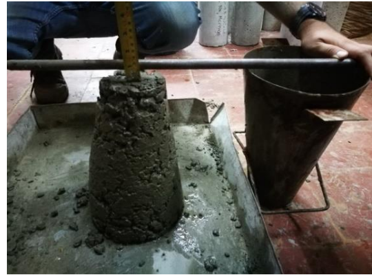
Figura 5. Prueba de verificación del asentamiento inicial.
