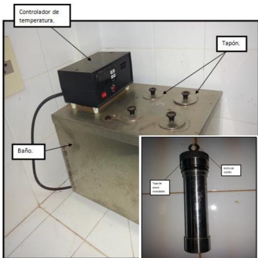
Fig. 6. Equipamiento para la observación de la corrosión a la lámina de cobre.
