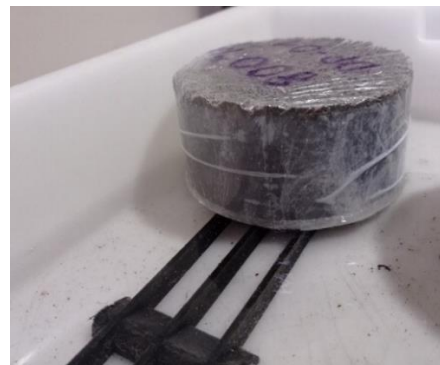
Figura 6: Ensayo de absorción capilar.
