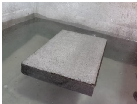
Figura 5: Bloque de hormigón celular de baja densidad flotando en tanque de curado.
