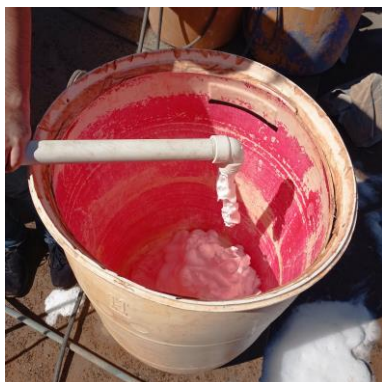
Figura 4: Descarga de espuma preformada en recipiente de volumen conocido.
