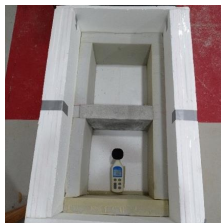
Figura 3. Cámara de transmisión para medición de reducción acústica.
