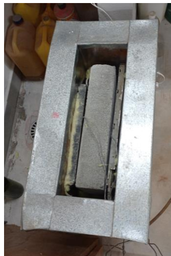
Figura 2. Artefacto de medición de la conductividad térmica con probeta de HC en su interior.
