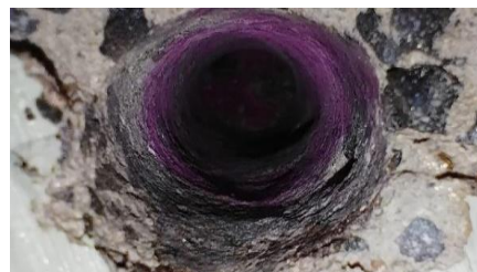
Fig. 3. Ensayo con solución de fenolftaleína.
