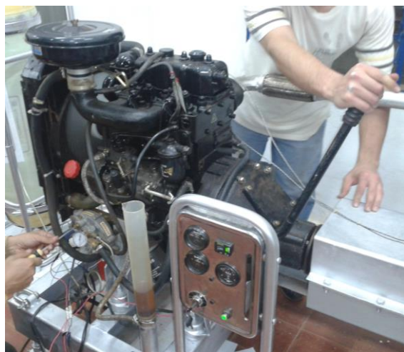
Fig. 2: Kit de conversión a sistema dual diésel-gas, motor de prueba y transmisión mecánica.
