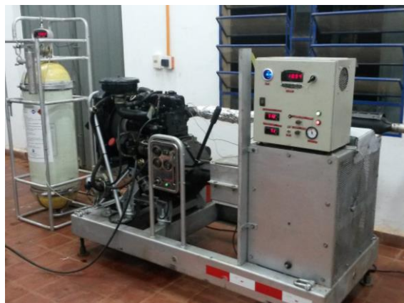
Fig. 1: Banco de prueba para motor y tanque de GNC, equipo instalado en el laboratorio de Termotecnia de la FIUNI.
