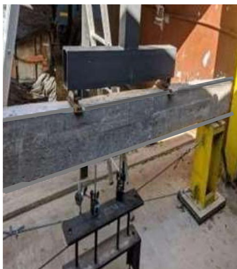
Fig. 4. Montaje para ensayo de una viga.
