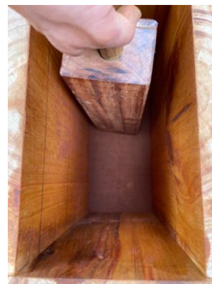
Fig. 3. Compactación de la primera capa de suelo utilizando el pison.
