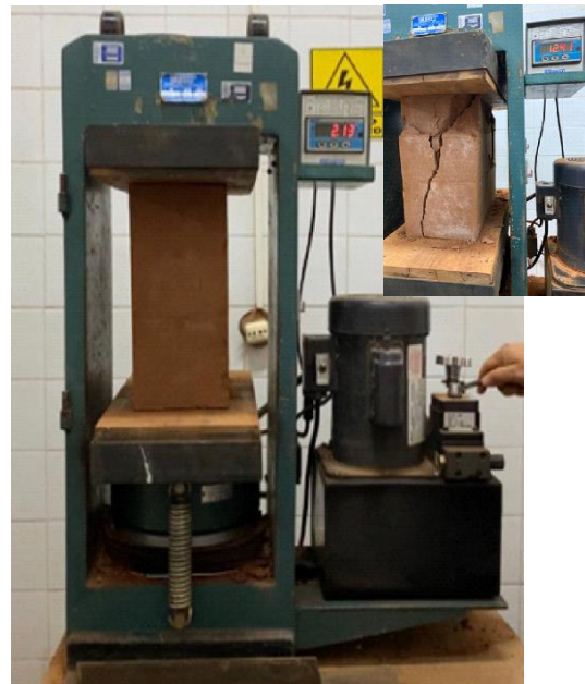
Fig. 6. Prensa hidráulica y bases de madera reforzada con ángulos de acero
