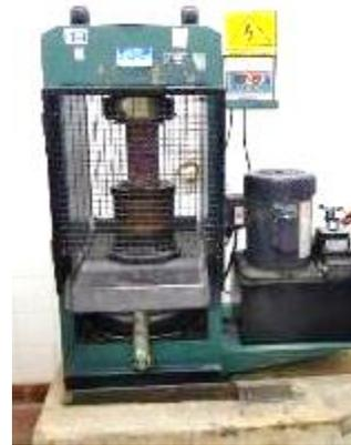
Fig.5. Prensa electro hidráulica para ensayo de probetas a compresión simple.
