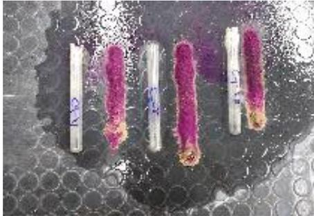
Fig.8. Muestras de polvo de hormigón luego de ser rociadas con el indicador de fenolftaleína.
