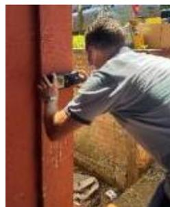
Fig.1. Escaneo de armadura.
