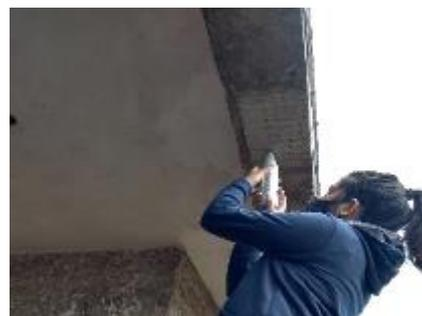
Fig.2. Empleo del esclerómetro.
