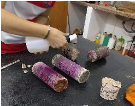
Fig.9. Rociado de testigos de hormigón con el indicador de fenolftaleína.
