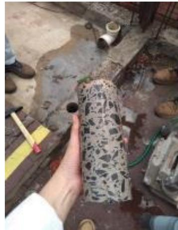
Fig.6. Núcleo de hormigón armado extraído de una viga.
