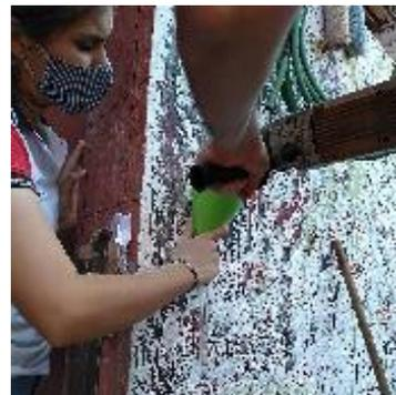
Fig.7. Obtención de polvo de hormigón.
