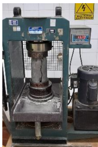
Fig. 5: Ensayo de rotura a compresión.
