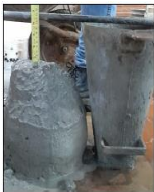
Fig. 4: Asentamiento del hormigón en el cono de Abrams.
