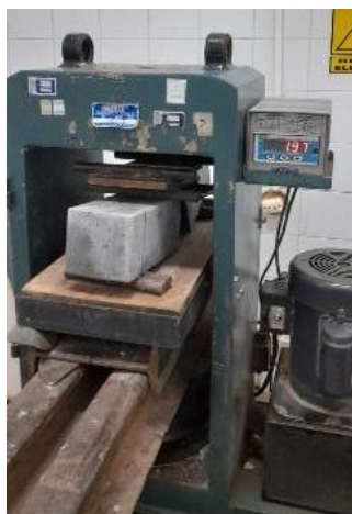
Fig. 6: Ensayo de rotura a flexotracción.
