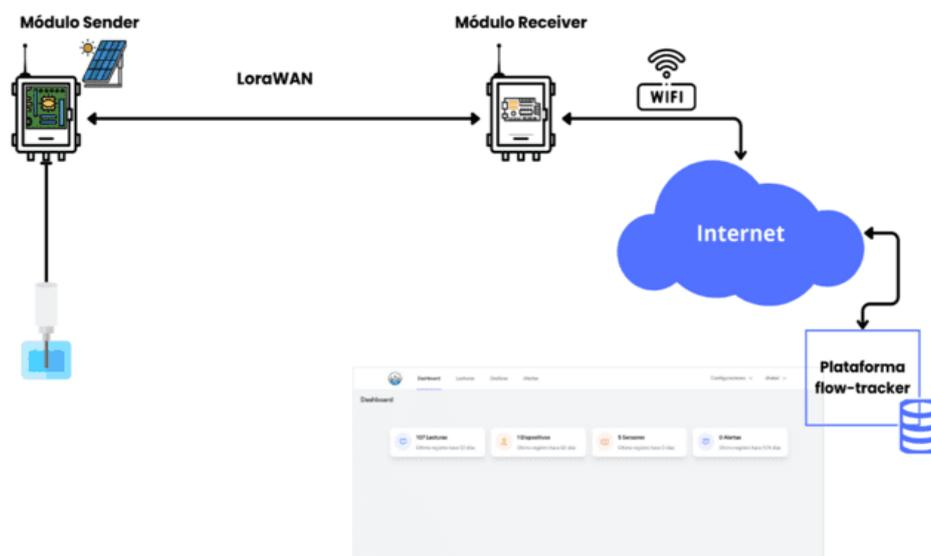
**Figura 1.** Arquitectura conceptual para la transmisión de datos.
