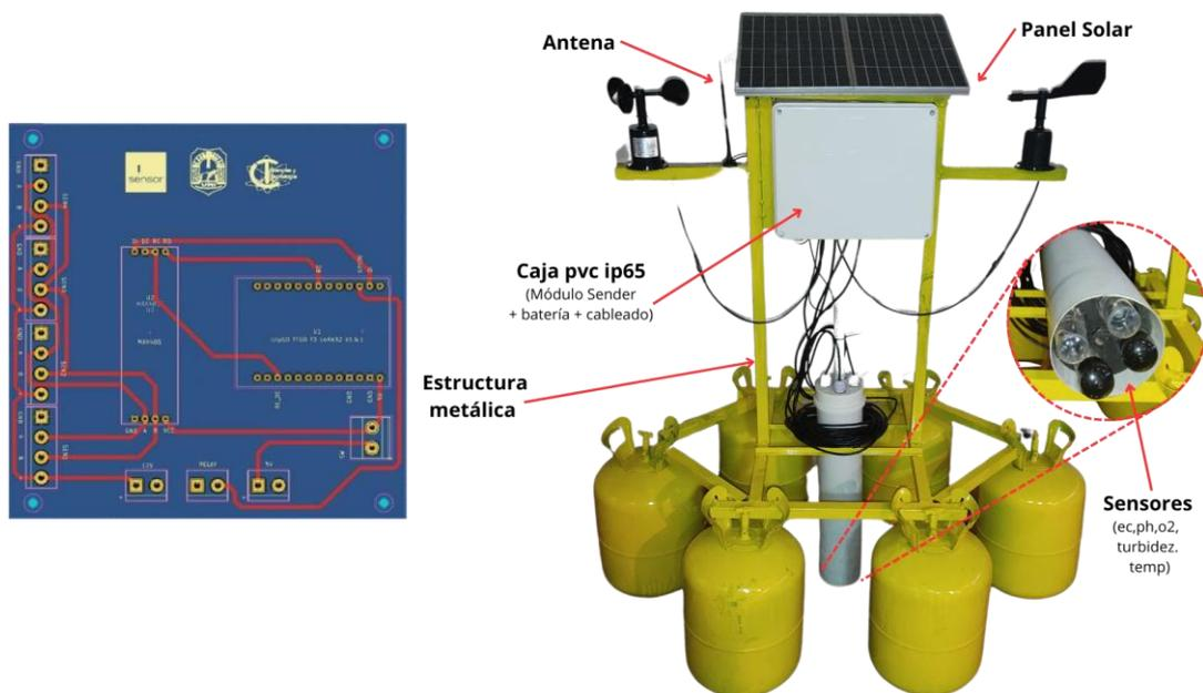
**Figura 3.** Izquierda: Diseño de PCB del módulo Sendero; Derecha: Prototipo terminado.
